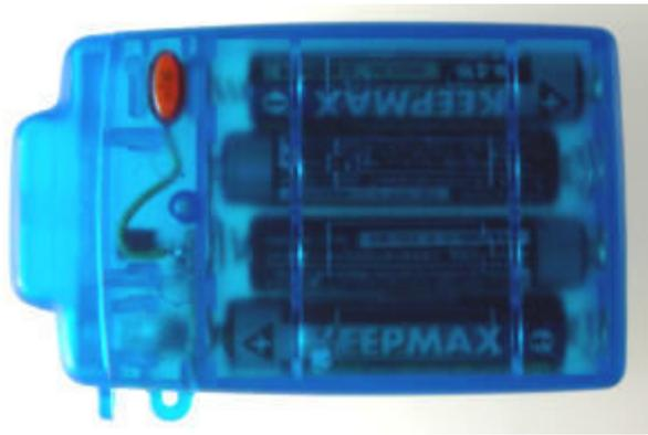
単四電池が4本入る充電器に、スイッチとLEDが内蔵されているものが100円均一店で売られていた。多分、回路は抵抗器1本でしようと考えながら購入。定電流回路を組み込んで長時間使用に変更、充電器回路は削除を考察。厚みが15mmですので、胸ポケットに入ります。画像は完成後のものです。
