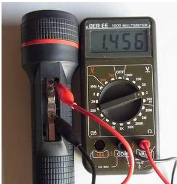
電池を入れて組み立てます。抵抗器の両端にテスターを当てます。表示は、2Vレンジで1.456を示しています。電流は、14.5mAとなります。データでは、電池電圧が、3.0Vの時に、16.8mAとなっています。微妙な電圧変化で数値が変わりますので、誤差の範囲としましょう。
