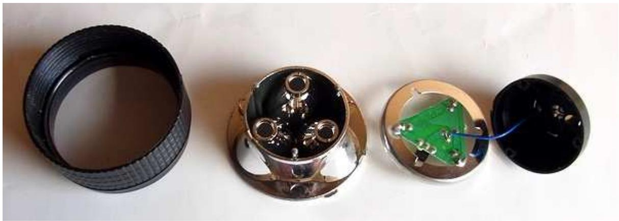
後は、図のように分かります。基板部分の線を外します。基板からICとコイルを外します。
