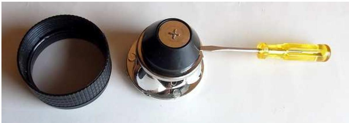
レンズ部分の枠から反射鏡の部分を左に回して取り出します。
