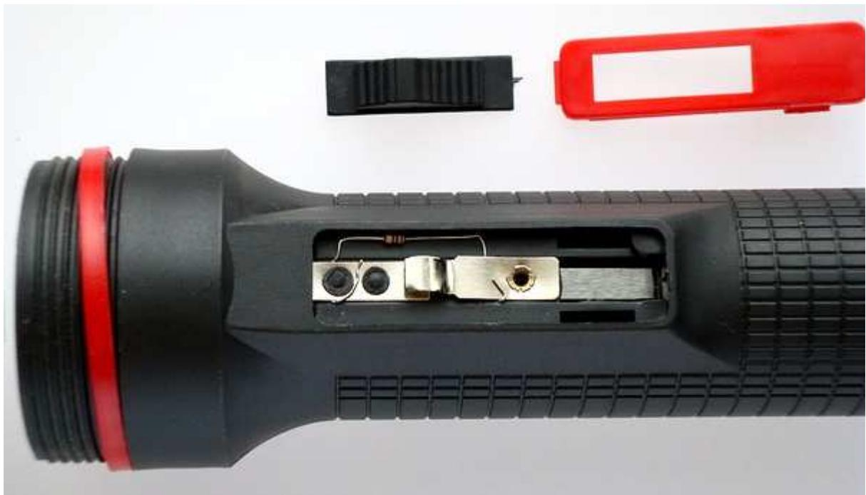
スイッチの金具を壊さないように注意して、抵抗のリード線を金属の下側に差し込み、カバーにぶつからないように先端を処理します。
