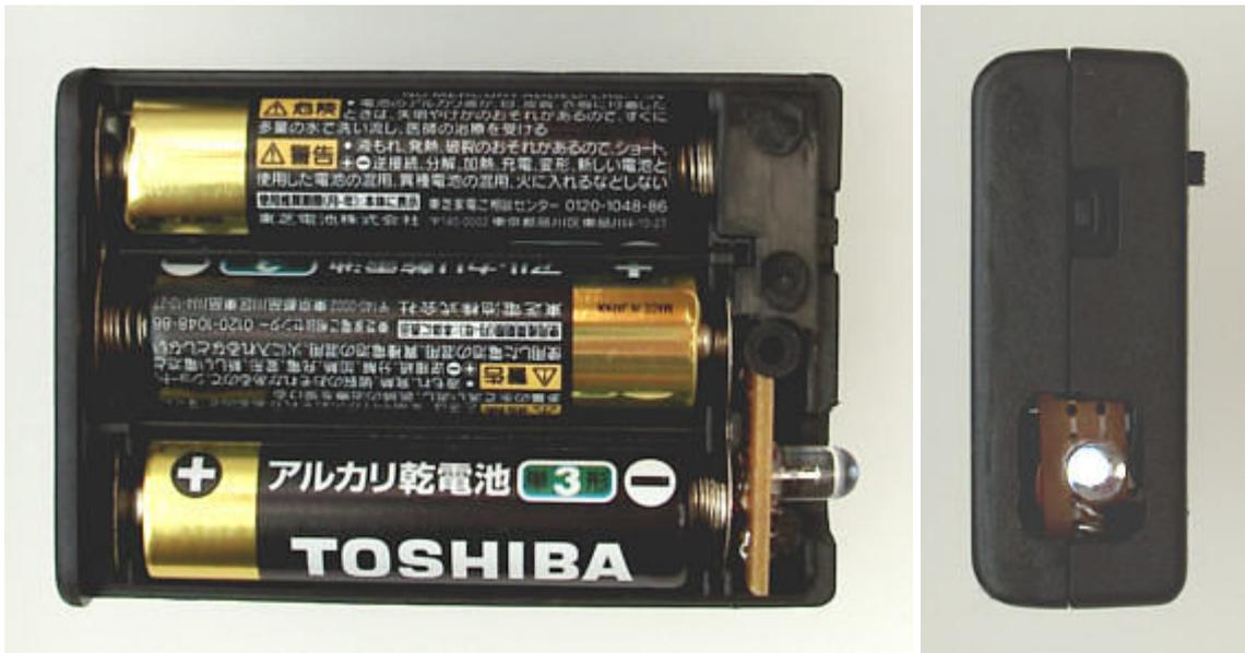
FETの2SK30を使って、1mAの定電流回路を作り単三3本の電池ケースにいれて、床から2メートル位の所に吊るし使ってみました。常時点灯です。
