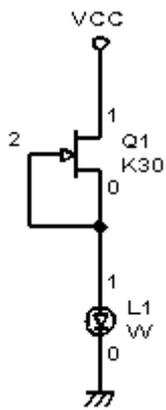
もう少し明ると、FETの2SK30を使って、2mAと2.5mAの定電流回路を作り電球のベースに入れます。
