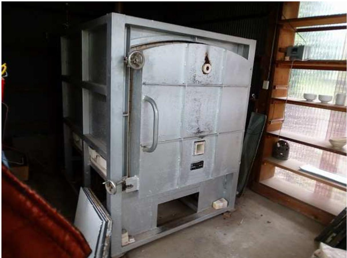
窯の全景、高さ、幅、奥行き、共に約2m。内容量0.3立方m。
